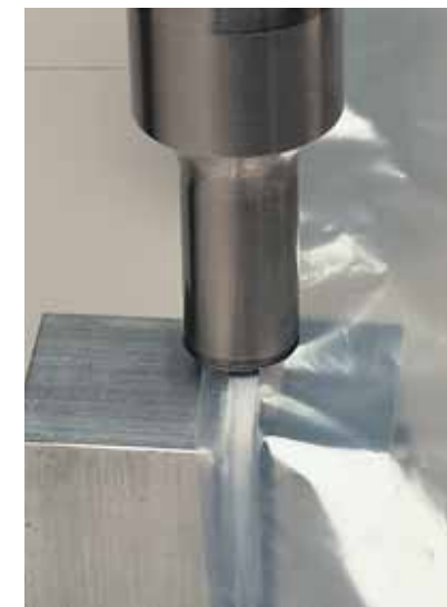
Непрерывная сварка пленки
